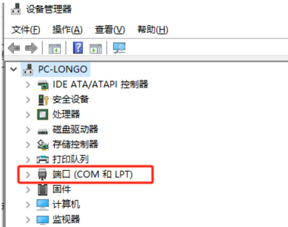
**注意：**ESP32S3开发板的COM串口一般是 **CH340** 或 **CH343** 芯片驱动的，带有 **CH34** 字样端口，或个别 **CP210** 等芯片驱动的，也是UART端口。
